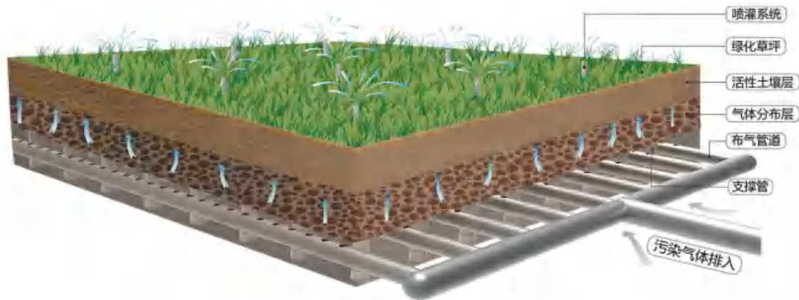
图 7.2-14 土壤除臭系统原理图
